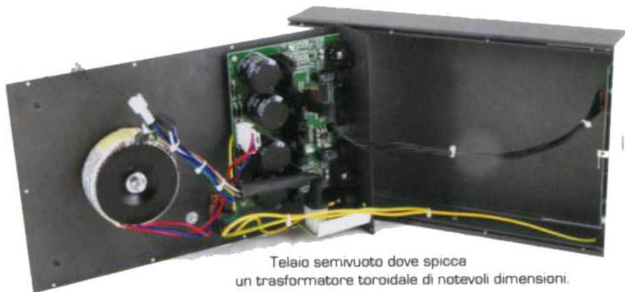
Telaio semivuoto dove spicca un trasformatore toroidale di notevoli dimensioni.
